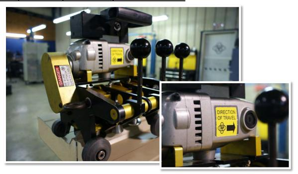
NOTICE: <u>DO NOT</u> HAND CRIMP CLIPS. HAND CRIMP IS ONLY TO START THE SEAMER.
